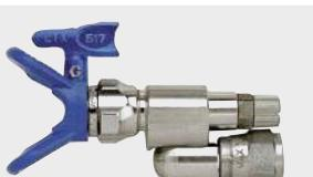
Потенциальной проблемой при использовании удлинительной насадки является разбрзгивание или вытекание краски из сопла распылителя. Наиболее простым решением этой проблемы является установка клапана CleanShot™ на окончание удлинительной насадки.
