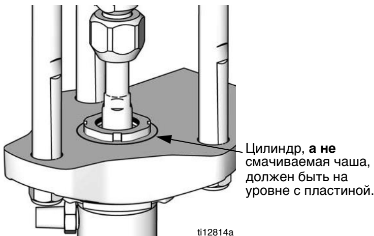
Рис.6. Выровняйте пластину переходника и цилиндр.
