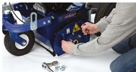
2. Удаление болтов и дверцы
