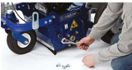
1. Откручивание четырех болтов
