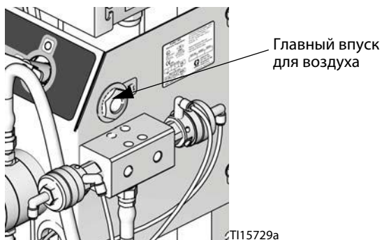
Рис. 3. Подключение главного воздухопровода
