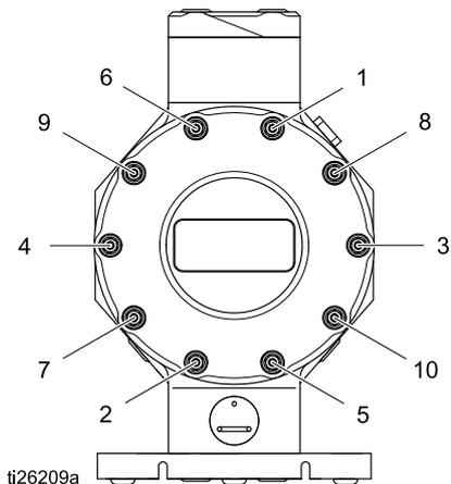
3. Далее поверните каждый винт на 1/2 оборота или менее, соблюдая перекрестную последовательность и установленное усилие затяжки.
