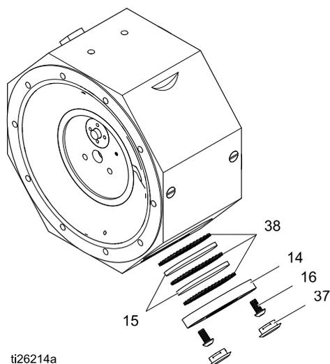
7. Уложите колпачок глушителя (14) поверх установленной рабочей среды глушителя, и используйте универсальный гаечный ключ на 4 мм для затягивания винтов (16). Затяните винты с усилием 16 дюймов на фунт (1,8 Н•м).
