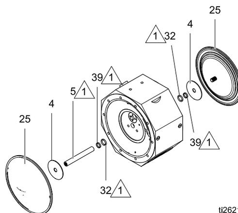
12. Смажьте вал, а затем установите его в сборочный узел пневматического двигателя. Проворачивайте диафрагму, пока Вы ее не сможете вдавить внутрь. Затем затяните другую диафрагму на валу только усилием руки.
