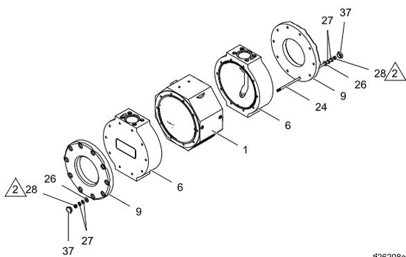
5. На резьбовом конце каждого стяжного болта (24) установите плоскую шайбу #12 (26), две тарельчатые шайбы (27) со скругленной стороной первой тарельчатой шайбы, обращенной к плоской шайбе, и со скругленной стороной второй тарельчатой шайбы, обращенной от плоской шайбы, и гайку (28). Пока не затягивайте.
