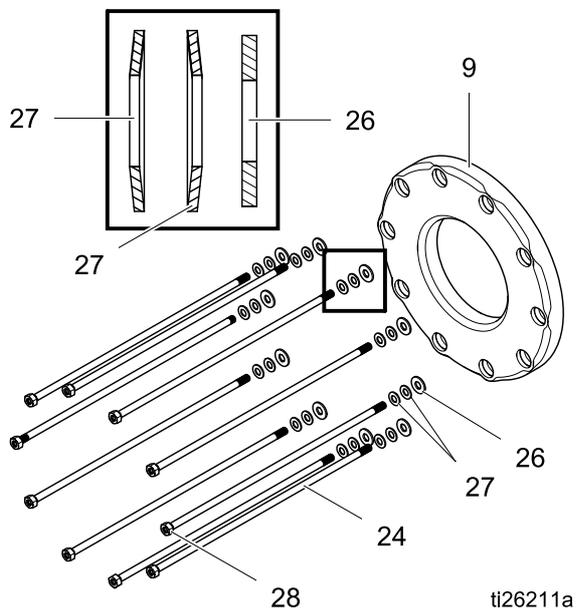
4. Сдвиньте стяжные болты (24) через фиксаторы (9), крышки жидкостной секции (6) и корпус (1), все ориентированы, как показано на рисунке. Используйте зажим для удержания секций вместе.
