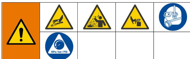
Это оборудование остается под давлением до тех пор, пока давление не будет сброшено вручную. Во избежание получения серьезной травмы от жидкости под давлением (например, в результате инъекции под кожу, разбрызгивания жидкости и от движущихся деталей), после завершения подачи и перед чисткой, проверкой либо обслуживанием оборудования выполняйте процедуру сброса давления.
