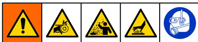
Чтобы снизить риск получения серьезной травмы, включая порезы или отсечение пальцев лопастями мешалки и попадание жидкости в глаза или на кожу, всегда выключайте мешалку и отключайте подачу питания на ЧРП перед подъемом, проверкой или ремонтом мешалки.
